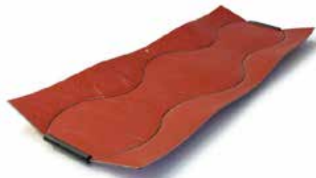
تصویر ۱ و ۲- ظروف نوین با عنوان موج ۱. پس از اینکه دستگاه CNC الگویی را که صنعتگر طراحی کرده در ورق مسطح کامپوزیت آلومینیومی برش داد؛ صنعتگر به صورت دستی آن را به شکل سه بعدی در می‌آورد. عملیات انجام شده آن را از شیئی صنعتی به صورت اثر دست ساز تبدیل می‌کند (URL7).
